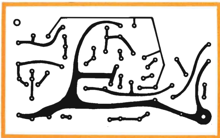
Fig. 6 - Il circuito stampato è d'obbligo per la realizzazione pratica del compressore di dinamica, perché questo deve ritenersi un apparato semiprofessionale.
